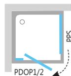
**Возможности использования:** При соединении неподвижной стены PPS и выбранного типа душевой двери вы получите душевой уголок квадратной или прямоугольной формы разных размеров. Вы можете выбирать между возможностями, указанными выше.
