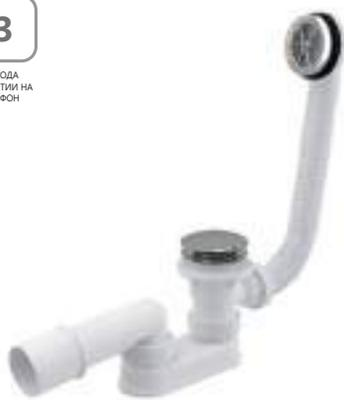
Предназначен для мини-ванны Sabina с отверстием для сифона и водосливом Ø52 мм. Слив воды регулируется с помощью системы ClickClick (при нажатии на сифон слив закрывается, при повторном нажатии слив открывается).
