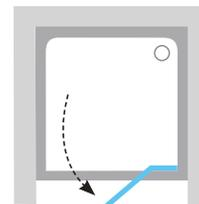
**Распашные двери / на петлях** снабжены подъемным механизмом, обеспечивающим приподнятое и фиксацию двери в основной позиции.
